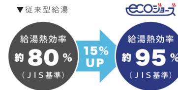
200℃におよぶ燃焼ガスの熱を新たな熱交換器で回収します。この熱を給水の予備加熱に再利用することで給湯熱効率が約15%も上昇しました。
