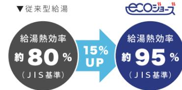
200℃におよぶ燃焼ガスの熱を新たな熱交換器で回収します。この熱を給水の予備加熱に再利用することで給湯熱効率が約15%も上昇しました。
